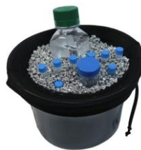
รูปที่ 2.8 ตัวอย่างตัวดูดซับสารเคมีและวัสดุกันกระแทก ที่ใช้ในการกั้นระหว่างขูดสารเคมีขณะเคลื่อนย้าย
