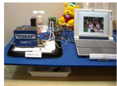
Alcohol fuel cell โดยใช้ Ethyl Alcohol + น้ำ เพื่อเป็นแหล่งไฟฟ้าของเครื่องใช้สำนักงาน ในงาน Nano Tech Tokyo ของบริษัท Toray
