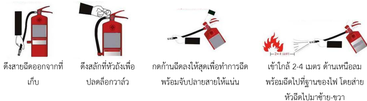
รูปที่ 6 การใช้ถังดับเพลิง
